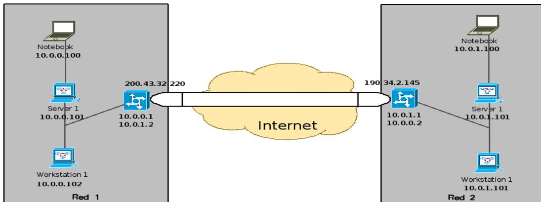
Como se ve en el diagrama, las ips de ambas redes a los extremos pertenecen a dos subredes distintas, esto es solo un ejemplo, pero es una solución conveniente para simplificar la configuración del ruteo.
